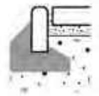
**entwässerungsrinnen //** Oberflächlich anfallendes Wasser muss auf möglichst kurzen Fließwegen zügig von der Oberfläche abgeleitet werden. Entwässerungsrinnen erhalten eine Längsneigung von mind. 0,5%. Die Elemente, z. B. Muldensteine, Rinnenplatten oder Pflastersteine, sind höhen- und fluchtgerecht auf ein Fundament aus Beton zu setzen und mit gebundenem Fugenmaterial zu verfugen. Entwässerungsrinnen sind mit Bewegungsfugen auszuführen.
