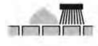
**abrütteln\* //** Platten werden nicht abgerüttelt und nur leicht mit einem Gummihammer festgeklopft.
